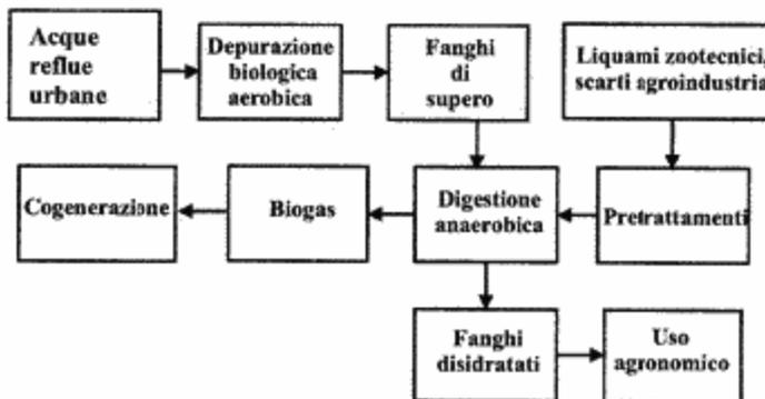
Gli impianti di depurazione di acque reflue urbane dotati di una linea di stabilizzazione fanghi con digestione anaerobica possono essere adeguati per effettuare la codigestione di liquami zootecnici o altri scarti agroindustriali, con un importante beneficio energetico (aumento del biogas prodotto) e in alcuni casi anche con un miglioramento dell'efficienza del comparto di denitrificazione che spesso richiede, per un buon funzionamento, una fonte aggiuntiva di carbonio.
