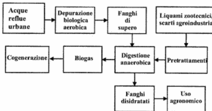
Figura 2 – Schema di flusso per il trattamento dei liquami zootecnici in depuratori di acque reflue urbane.
