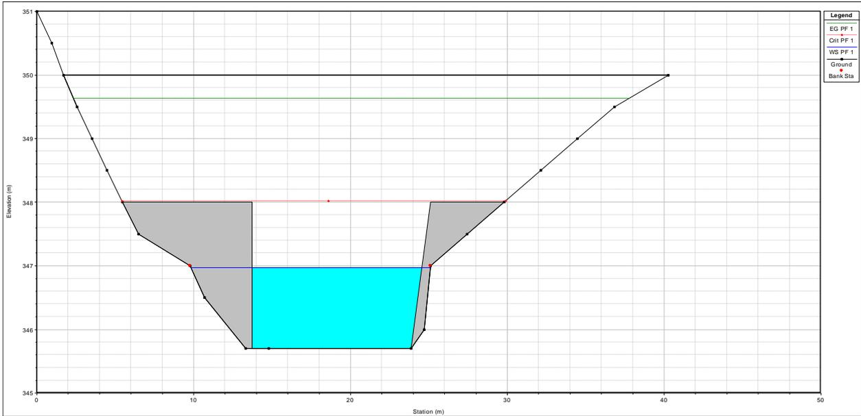
Figura 14: Deflusso della portata con  $Tr=100$  anni attraverso la nuova briglia – stato di progetto
